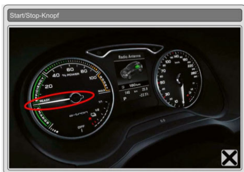
Foto links: Die Anzeige am Armaturenbrett weist auf die Fahrbereitschaft hin, und die Tankanzeige (rot eingekreist) verrät, ob es sich um einen alternativen Antrieb handelt.
